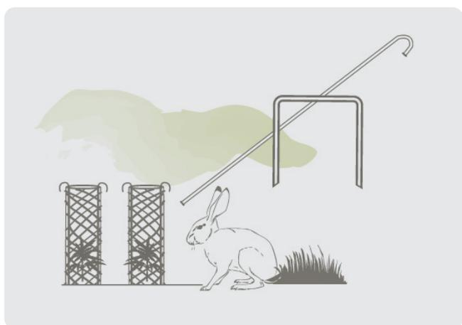
GRIPLAST réalise des tuteurs de palissage en forme de U ou bien droits qui sont utilisés pour protéger le plant de vigne des passages inter-ceps.
